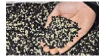
Stefan Haase, Technischer Betriebsleiter, zeigt das Grundprodukt für die Herstellung der Dichtungsbahnen: Kunststoffgranulat.
