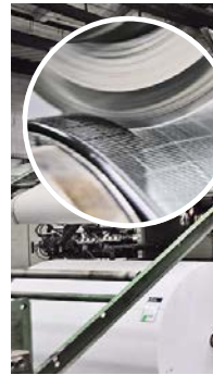
Extruderlinie: Fertigstellung der Kunststoffdichtungsbahn mit Randbeschnitt.
